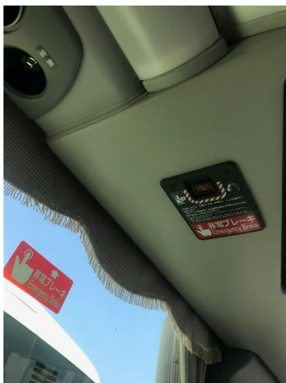
【ドライバー異常時対応システム EDSS 装置導入貸切車両】
