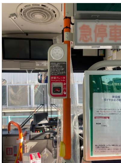
【ドライバー異常時対応システム EDSS 装置導入乗合車両】
